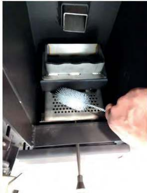
CZYSZCZENIE KOMORY piecyka (szczotka nie jest dołączana do piecyka)
