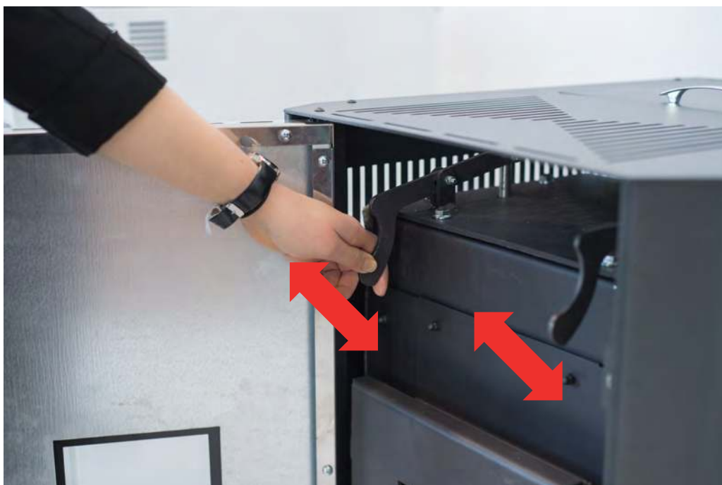
Czyszczenie zawirowywaczy spalin
