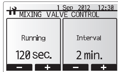
Ekran ustawianie zaworu mieszającego
